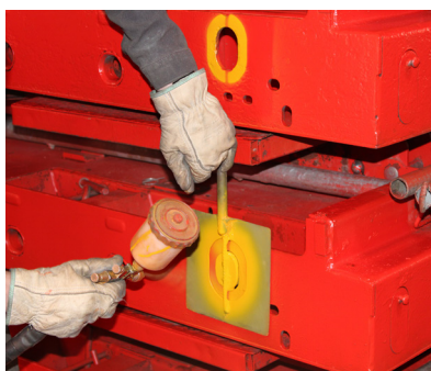
Mise en évidence des points de manutention
