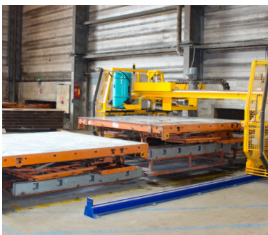
Ponçage automatisé 1 ère phase
