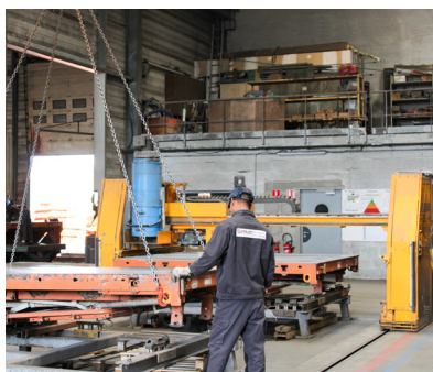
Second ponçage automatisé en finition
